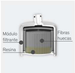
Sección de filtro para grifo BIOFIL
